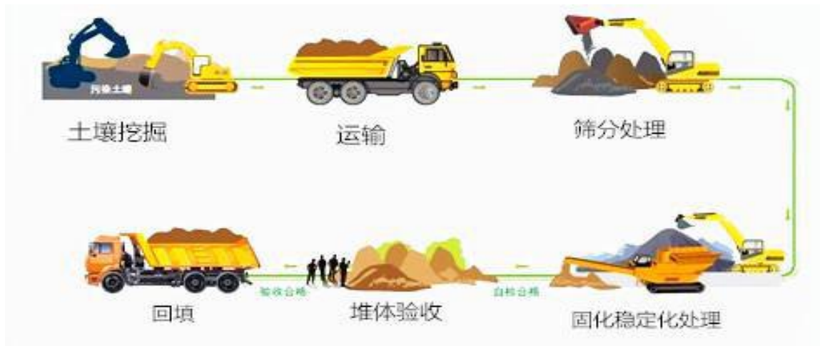
图 4.1-2 异位固化/稳定化土壤修复示意图
